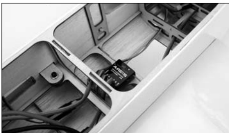
AR6115 eingebaut im Flugzeug
