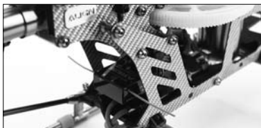
AR6115 eingebaut im Helikopter
